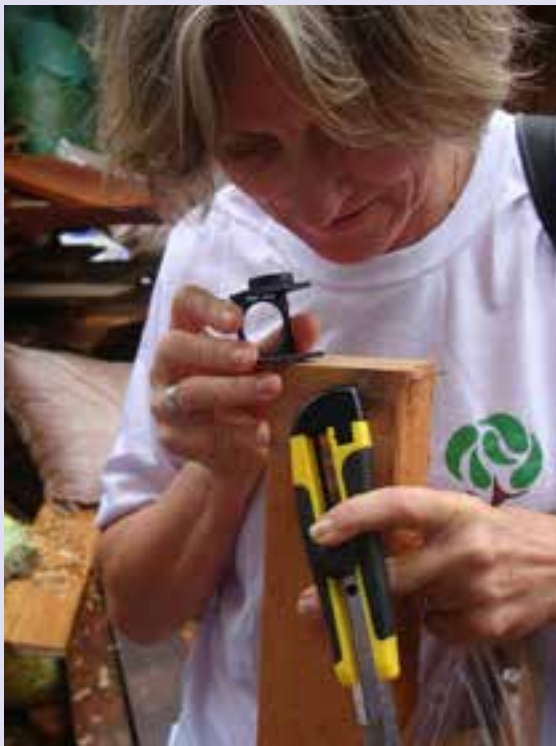
Ahli anatomi kayu mengidentifikasi potongan kayu di suatu pabrik kayu di Brazil ©NIRS Mahogany ID Project'
