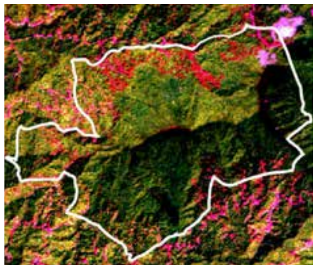
Citra Landsat yang menunjukkan kerusakan vegetasi yang ditonjolkan menggunakan pewarna pita infra-merah. Jalan logging ditunjukkan dengan warna merah muda, kegiatan penebangan intensif warna merah, area-area yang sudah ditebang sebelumnya hijau muda. Teknik ini bisa mengidentifikasi aktivitas penebangan kayu secara selektif. Gambar ini menunjukkan penebangan didalam wilayah lindung pegunungan Batu Lawi di Sarawak oleh perusahaan Malaysia bernama Samling. ©EarthSight
